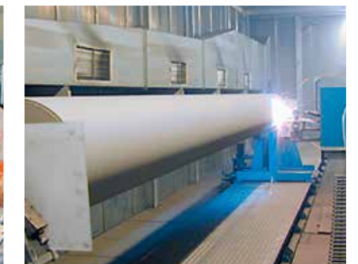
Walze während der thermischen Beschichtung
